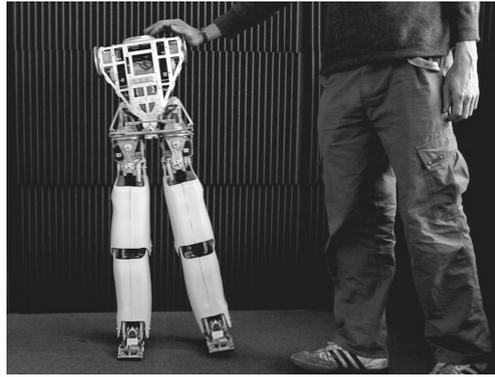
Abbildung 3.7.: Links: Kopplung zweier CSL-Strukturen um Bewegungen gegeneinander zu vermeiden. Rechts: Balancierender Myon-Körper ohne Arme und Kopf.
